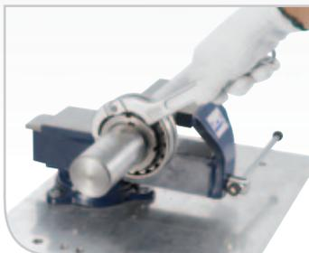
► El montaje en caliente permite, por el aumento de temperatura del rodamiento, dilatar el anillo interior para instalarlo sin esfuerzo sobre su eje.
