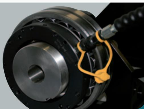
Extracción del manguito de desmontaje apriete con el tuerca hidráulica (montaje inverso la precedente)
