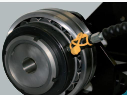
Extracción del manguito de apriete con la tuerca hidráulica
